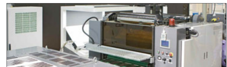
MMT's C 2 is running inline with a Shinohara 755 press Die innovative Maschine zur Stanzung holografischer Effekte in beschichtete Bogen
