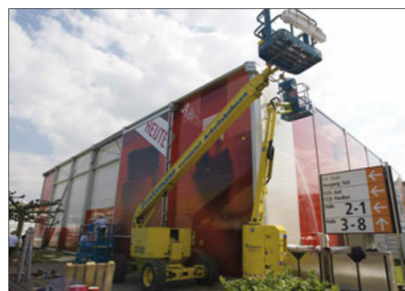
Banner Lifter handles the switchover with no complications Nur rund 20 Minuten dauert der tägliche Megaprint-Wechsel ...
