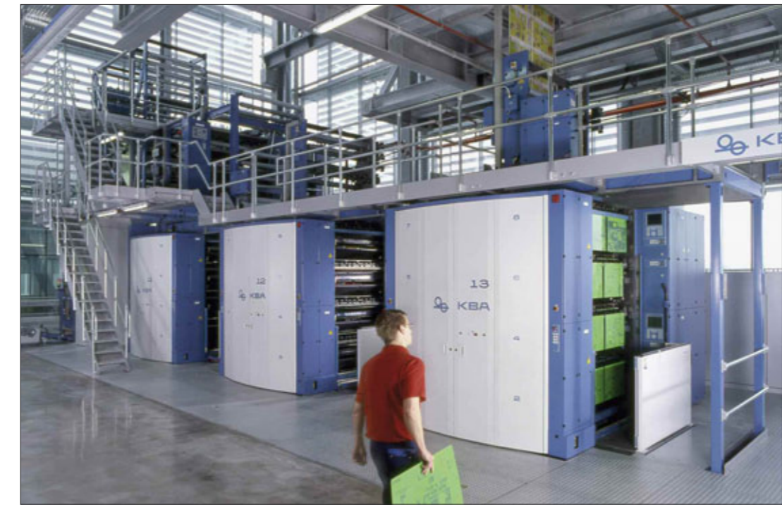
Cortina: more and more printers are making the transition to environmentally responsible newspaper production Die umweltorientierte Zeitungsproduktion mit der wasserlos druckenden KBA Cortina findet immer mehr Anhänger.
