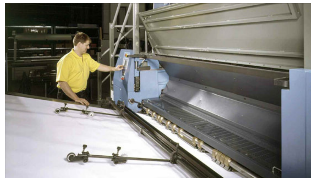
The 205 has a massive sheet size of 1,510x2,050mm and prints at speeds of up to 9,000 sheets per hour Im Vergleich zum Bediener wird die Größe des Papierformats auf dem Anlegstisch des Super-Jumbos besonders deutlich.
