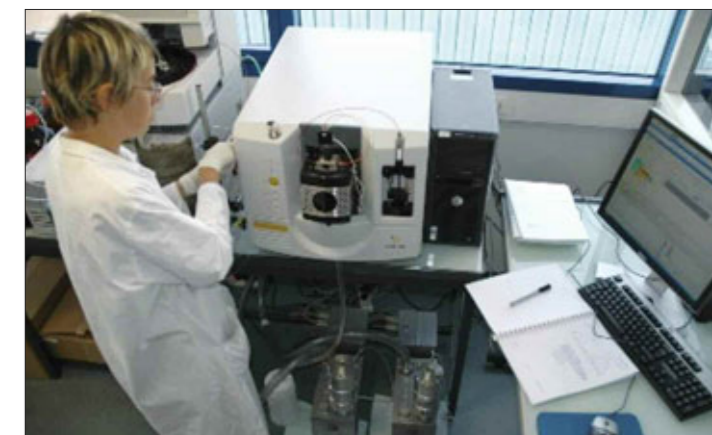
A liquid chromatograph/mass spectrometer may be used to measure impurities Ein LC/MS-System (Flüssigchromatograph/Massenspektrometer) misst Verunreinigungen.
