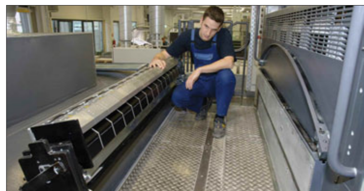
InlineColorPilot is installed behind the impression cylinder on the last print unit. Der Inline Color Pilot im Großformat, hier bei der Druckerei Himmer AG in Augsburg.
