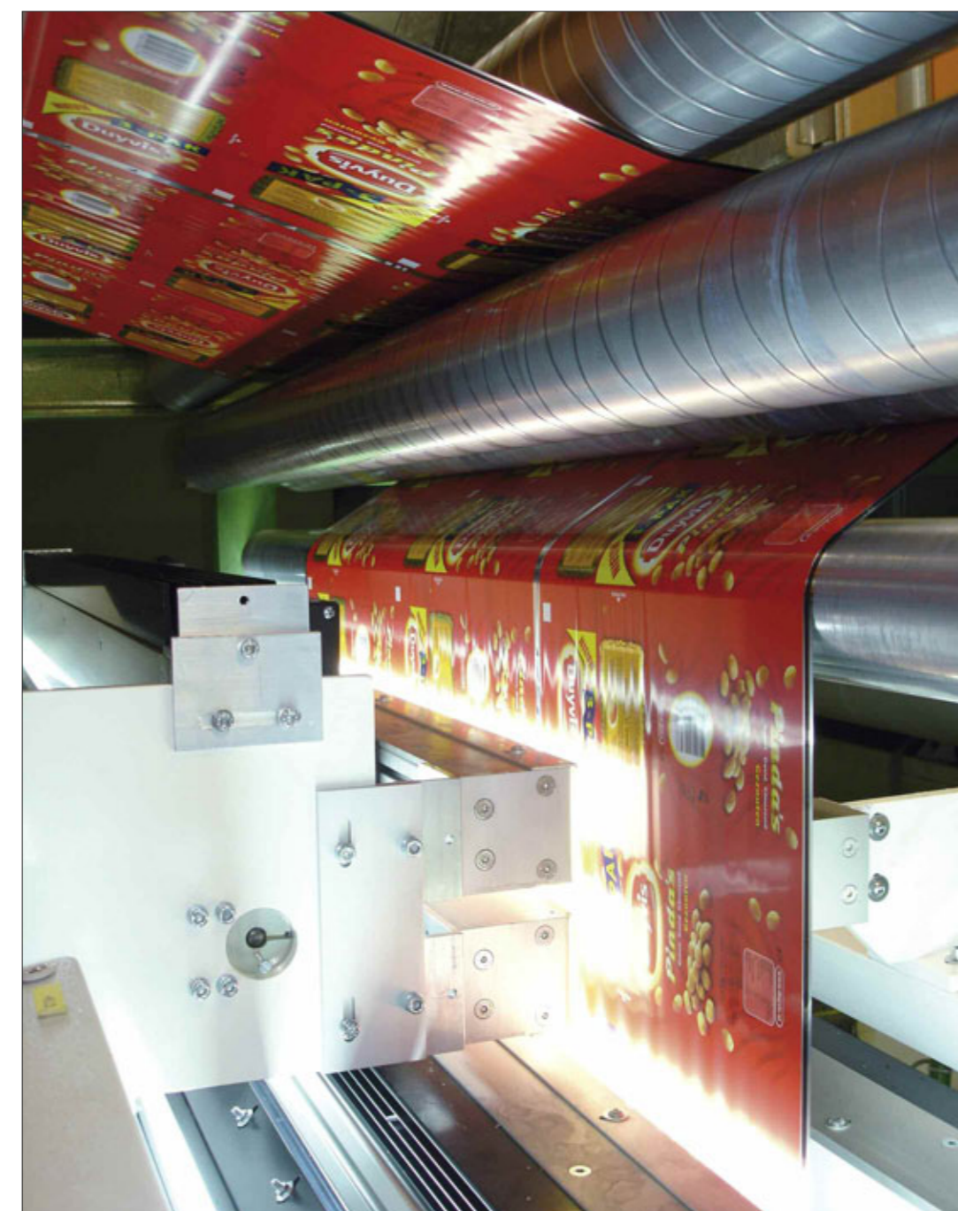
Isra Vision: inspection systems for a wide array of processes, from flexible packaging to sheetfed print Lückenlos höchste Druckqualität dank hundertprozentiger Inspektion im Verpackungstiefdruck
