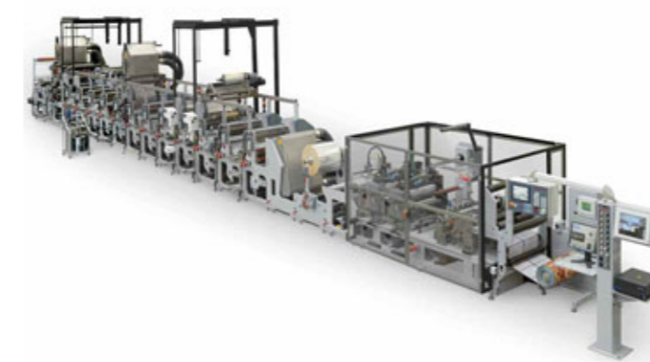
The VaryFlex-F1 is constructed in a modular fashion Die VaryFlex-F1 ist modular aufgebaut.
