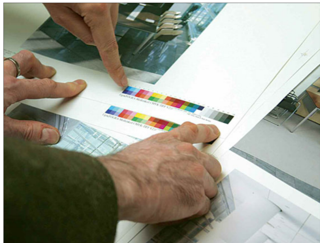
ISO 12647: helping control colour consistency throughout the print workflow Die Überprüfbarkeit von Genauigkeit und Homogenität der Farbe stellt für Druckdienstleister einen Wettbewerbsvorteil dar.
